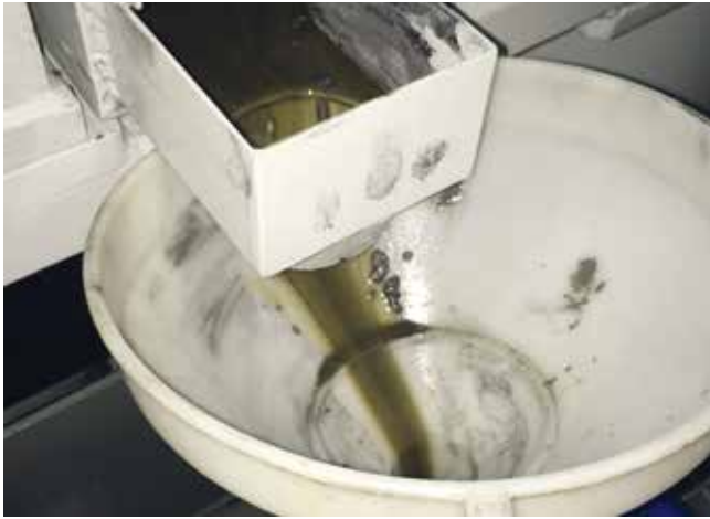
2 Die herausgepressten KSS werden aufgefangen und können dem KSS-Kreislauf wieder zugeführt werden. (Bild: Di Più)
